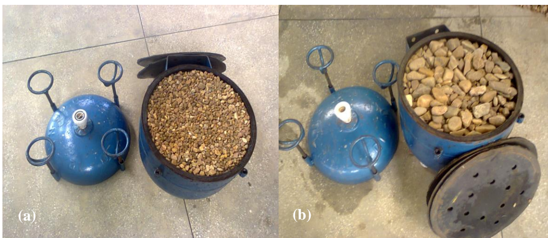
Figura 2. Variações do filtro artesanal de areia com uso de cascalho médio (a) e grande (b).
