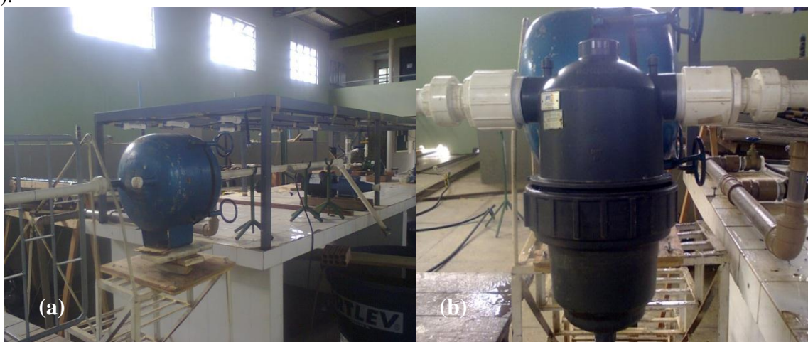
Figura 1. Esquema do filtro artesanal de areia (a) e de disco (b) montados na bancada hidráulica.
